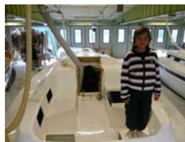
Deck und Rumpf werden vor dem Innenausbau verschraubt und laminiert
